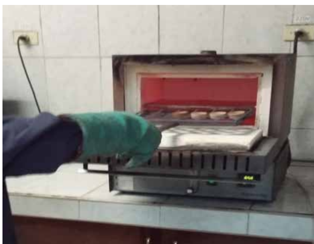
Figura 1. Ingreso de muestras en la mufla (Thermolyne F6020C-33-60-80) a 750 °C, cumpliendo con las normas de seguridad del laboratorio (Guante protector, bata antiflama y careta protectora). Fuente: propia.
